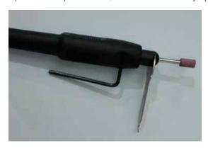
5. Sujete el mango del eje flexible con una mano y gire el accesorio con la otra mano.
