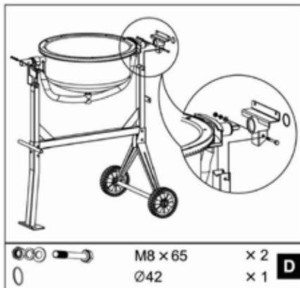
3. A cada lado, alinee los agujeros en el soporte lateral con los del bloque de apoyo e inserte un perno hexagonal M8x65 de un lado, y luego una arandela plana, la arandela de seguridad y la tuerca del otro lado. Apriete con una llave.
