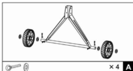
2. Con el marco acostado de lado, coloque la pierna de apoyo, como se muestra. Inserte dos tornillos hexagonales M8x70 a través de los agujeros de un lado, y arandelas planas, arandelas de seguridad y tuercas desde el otro lado. También, fije el tornillo hexagonal M8x55 con arandela de seguridad, plana y tuerca en el marco. Apriete hacia abajo.
